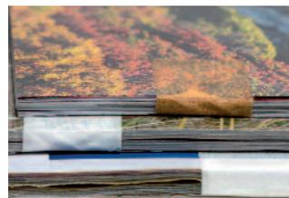
Für *ferag.ecofix* wird ein speziell entwickeltes Material aus Naturfaser und Naturkautschuk eingesetzt, das restlos ablösbar und vollständig recycelbar ist. Es kann zusammen mit den Zeitschriften ins Altpapier oder auch kompostiert werden.
