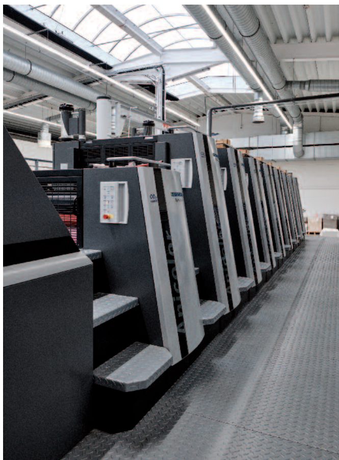
PackEx produziert auf einer Speedmaster XL 75-8+L Verpackungen für Produkte aus der Pharma-, Kosmetik-, Lebensmittel- und Werbebranche ausschließlich im Multicolor-Verfahren.
