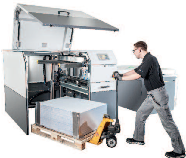
Der Kodak Magnus Q800 Plattenbelichter mit Mehrpalettenlader (MPL). In den MPL können Paletten eingeführt werden, auf denen sich bis zu 1.500 Platten befinden.
