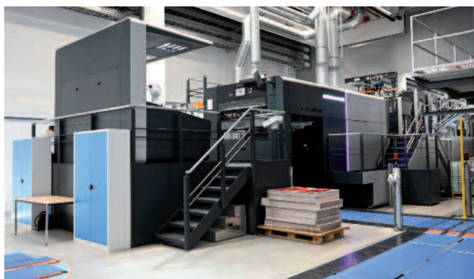
Die Bedruckstofflogistik erfolgt an der rund einen Meter höher gesetzten Rapida 164 über ein stapelloses Unterflursystem.
