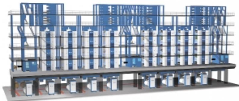
**TROCKNER AN ROLLENOFFSETMASCHINEN**
