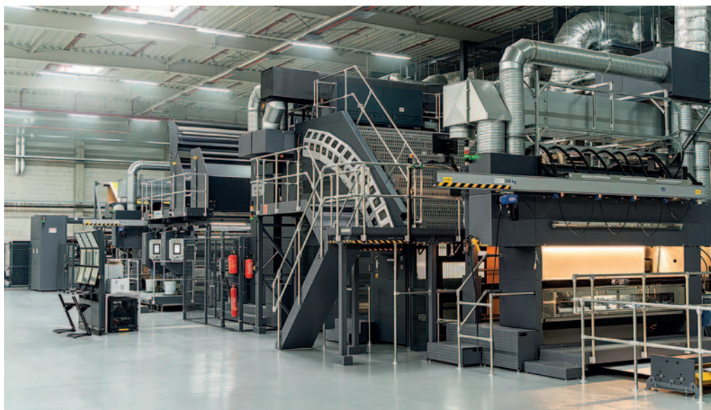
Die digitale Rollendruckmaschine HP PageWide T1195i Press bei Thimm in Alzey verfügt über eine Arbeitsbreite von 2,86 m und erreicht Geschwindigkeiten bis zu 305 m/Min.
