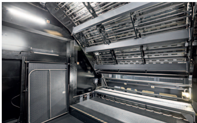
Dank der für HP typischen gewölbten Konstruktion lassen sich die Papierspannung und der Abstand zwischen Druckkopf und dem Papier optimal kontrollieren.
