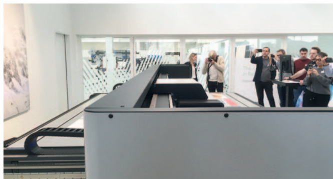
Der Flachbettdrucker Nyala 5 lässt sich von beiden Seiten bedienen. Während im rechten Teil gedruckt wird, kann der Drucker auf der gegenüberliegenden Seite mit Material bestückt werden.
