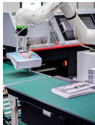
Roboterarme übernehmen die Zuführung von Buchblöcken bei der vollautomatischen Buchproduktion.
