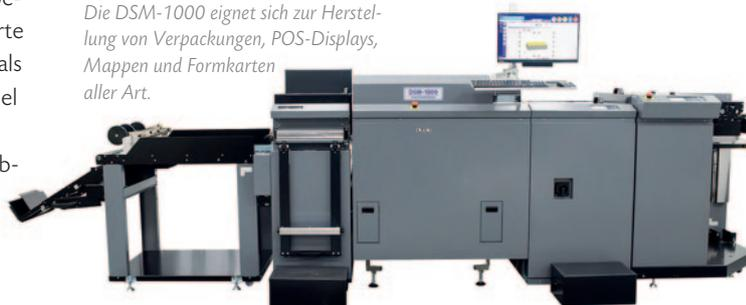
Eine universelle Adapterplatte ermöglicht es zudem, bereits bestehende Stanzformen zum Beispiel vom *Tiegel* auf der *DSM-1000* zu verwenden, ohne dass diese neu erstellt oder umgebaut werden müssen.
