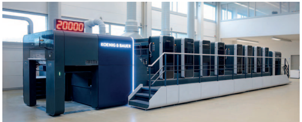
Typische Akzidenzmaschine: Die Rapida 106 X mit acht Farbwerken und Bogenwendung für die 4-über-4-Produktion produziert auch im Schön- und Widerdruck mit Leistungen bis zu 20.000 Bogen/h.
