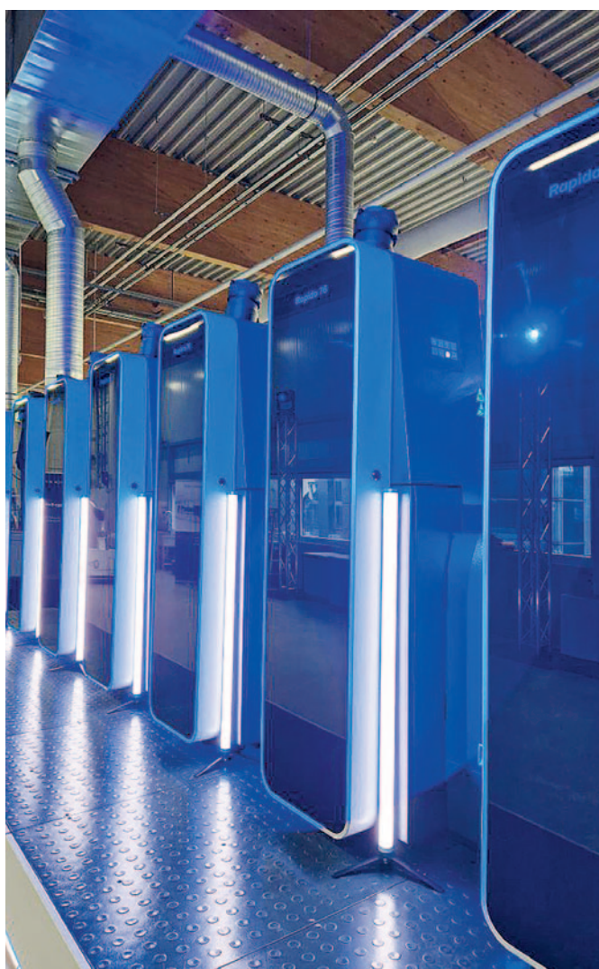
Die Rapida 76 bewies beim Open House ihre Flexibilität für den Akzidenz-, Label- und Verpackungsdruck – basierend auf der Technologie-Plattform der Mittelformat-Maschine Rapida 106 . Installiert ist im Koenig & Bauer Kundenzentrum eine Siebenfarben- Rapida 76 für das maximale Bogenformat 605 x 750 mm.
