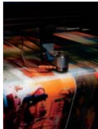
Der Opimatic Auftragekopf AKS-100 klebt mit 1 kg Klebstoff bis zu 50 km Papierbahn.
