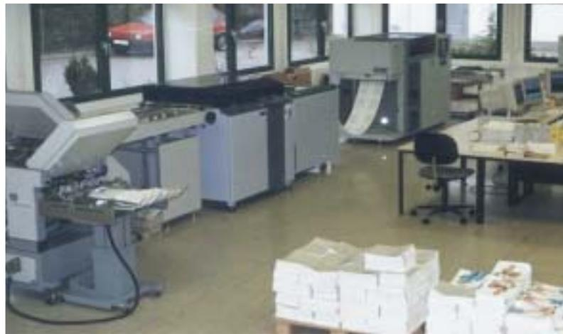
Falzarten sind frei programmierbar. Wiederholaufträge können abgespeichert und bei Bedarf automatisch eingerichtet werden. Auch die Falzwalzeneinstellung erfolgt durch Computerunterstützung.
