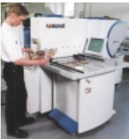
rungsköpfen von Presstek, die einen breiteren Tonwertumfang als vergleichbare DI-Maschinen dieser Formatklasse mit älterer Bebilderungstechnik erlauben. Außerdem kann die Bebilderung bei stehender Maschine mit hoher Geschwindigkeit erfolgen und das Farbwerk verfügt über vier anstelle von drei Farbauftragwalzen bei ähnlichen Wettbewerbsmaschinen.
