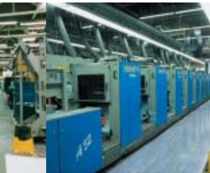
An der Müller Martini Concept (links), wie sie auch bei Moselle Vieillemand produziert, lässt sich ein Formatwechsel mit Hilfe der Zylinder-Einschübe und dem Schienensystem in kurzer Zeit durchführen. Mailings mit größeren Auflagen werden bei Rainbow Graphics in Des Plaines auf der neuen Achtfarben A52 (oben)gedruckt. Die A68 (rechts) ist eine Rollenoffsetmaschine für den umfangvariablen Akzidenzdruck.
