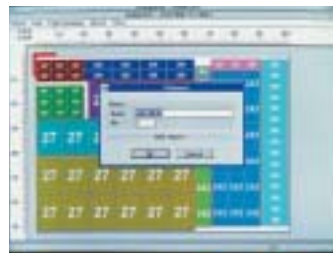
Als gesonderter Compucut-Arbeitsplatz dient ein handelsüblicher PC. Auf diesem können Schneidprogramme erstellt und an das Schneidsystem übermittelt werden oder die Daten (CIP3) aus der Druckvorstufe übernommen werden. Oben das entsprechende Menü.
