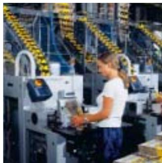
**Einstecktrommeln, wie sie Ferag für Zeitungshäuser und -druckereien konstruiert, eröffnen den Verlagen völlig neue Möglichkeiten des Komplettierens, Strukturierens und Regionalisierens in einer Produktionslinie – automatisch und online. Die Anleger verfügen über eine schnelle Formateinstellung vom Postkartenformat bis zur Zeitungsgroße. Damit werden die Umrüstzeiten reduziert und die Anlaufqualität gleichzeitig erhöht.**
