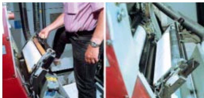
Die Wascheinheiten der Baldwin IMPACT-Gummituchwaschanlage sind als leicht herausnehmbare Wechselkassetten ausgeführt.
