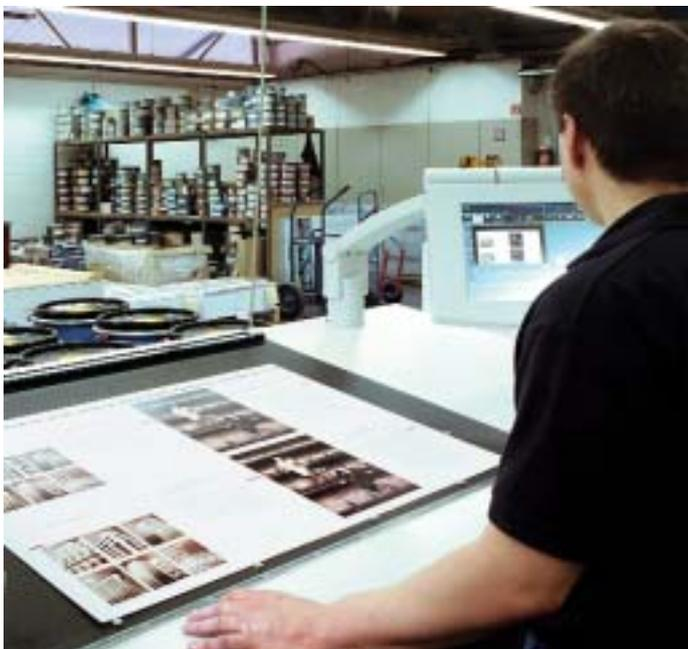
Systematische Farbmessung auch im Drucksaal und direkt am Leitstand der Maschine dehnt die Reichweite des Color-Managements bis in den Auflagedruck aus.
