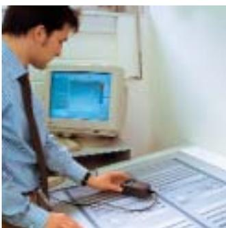
Alles innerhalb der zulässigen Toleranz? Die regelmäßige messtechnische Kontrolle der digital erstellten Druckformen liefert letzte Sicherheit.
