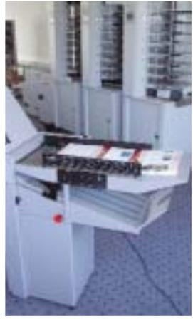
entgegenwirkt. Der serienmäßige Perforiereinsatz perforiert und falzt selbst Karton. Verschiedene Perforierwerkzeuge sowie diverse Rillwerkzeuge und Schneidmesser sind dafür erhältlich. Zum Lieferumfang gehören auch Vorwahl- und Auflagenzähler, was nachträgliches Abzählen von Partien erspart.
