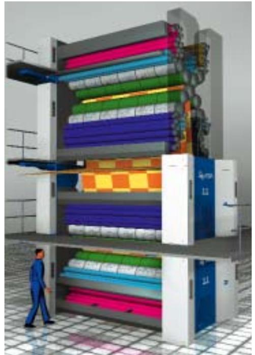
sechs Platten in der Breite und zwei Platten im Umfang auf dem Druckzylinder verbindet. Das Konzept mit 24 Seiten pro Zylinderumdrehung bringt nach Angaben von MAN Roland eine um 50% höhere Seitenkapazität bei gleicher Geschwindigkeit im Vergleich zum 4/2-
