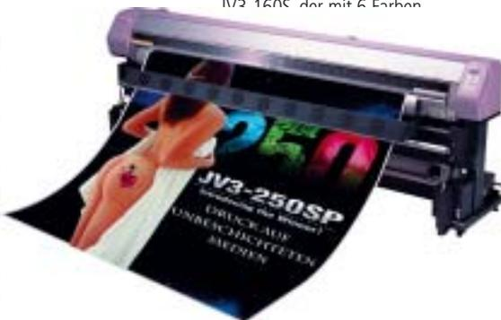
liefert. Durch die Unterstützung variabler Punktgrößen werden feinste Abstufungen erreicht. Dies ermöglicht kürzere Rip-Zeiten, geringeren Tintenverbrauch und Geschwindigkeiten von bis zu 30 m<sup>2</sup>/Stunde bei 360dpi. Fotorealistische Drucke erreicht der JV3-250Sp mit der Maximalauflösung von 1.440dpi. [www.nbn.de](http://www.nbn.de)
