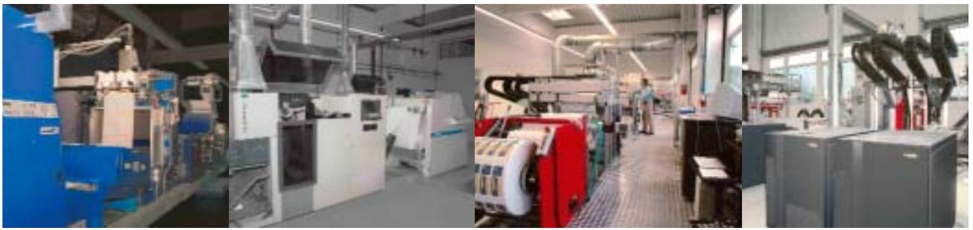
Drei Technologien arbeiten bei Datacolor Hand in Hand: Endlos-Offsetmaschinen, Laserdrucker und Inkjet-Technologie. Auf einer der Rotationsdruckmaschinen (links) hat Datacolor die Möglichkeit, mit 3 VersaMark Dijit 6240 Inkjet-Köpfen auf die vorgedruckte Bahn mit 150 m/min. zu drucken.
