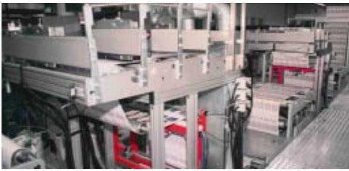
Die VersaMark Schön- und Wider-Inkjetdruck-Anlage: links das Druckgestell für maximal drei VersaMark 9-Zoll-Inkjetköpfe neben einander und eine maximale Druckbreite von 68 cm. Nach dem Wenden der Papierbahn erfolgt der Inkjet-Widerdruck.
