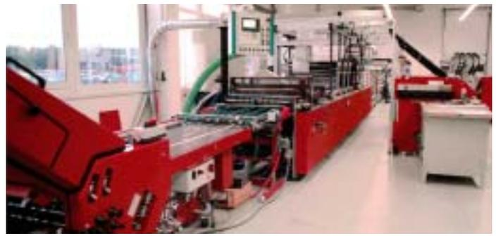
Nach der VersaMark läuft die Bahn durch eine Finishing-Anlage, wobei Produkte auch gefalzt werden können. Rechts können noch weitere maximal vier Bahnen beigefügt werden.
