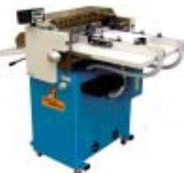
Air Modelle werden komplett geliefert mit Anlege- und Ablagetisch, Seitenanschlügen, Werkzeugen für Strich-, Mikroperforation, Schneiden, Halbschnitt und Nutung. Die geringste Arbeitsbreite beträgt 90 mm, die minimale Arbeitslänge 120 mm. Mit diesen Merkmalen ausgestattet, eignen sich die Master Air Modelle besonders für den Einsatz bei schwierigem Material zum gleichzeitigen Strichperforieren, Mikroperforieren, Nuten, Schnitt und Halbschnitt. > [www.foellmer.com](http://www.foellmer.com)
