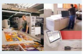
Seit der Einführung von CtP druckt die Roland 705 immer öfter Aufträge mit der Staccato-FM-Rasterung. Der Trendsetter 800 Quantum hat den Hinckel-Druck den Abschied von Computerto-Film leicht gemacht. Ständige Prozessüberwachung wird auch nach dem Übergang zur digitalen Druckplattenbebilderung groß geschrieben.
