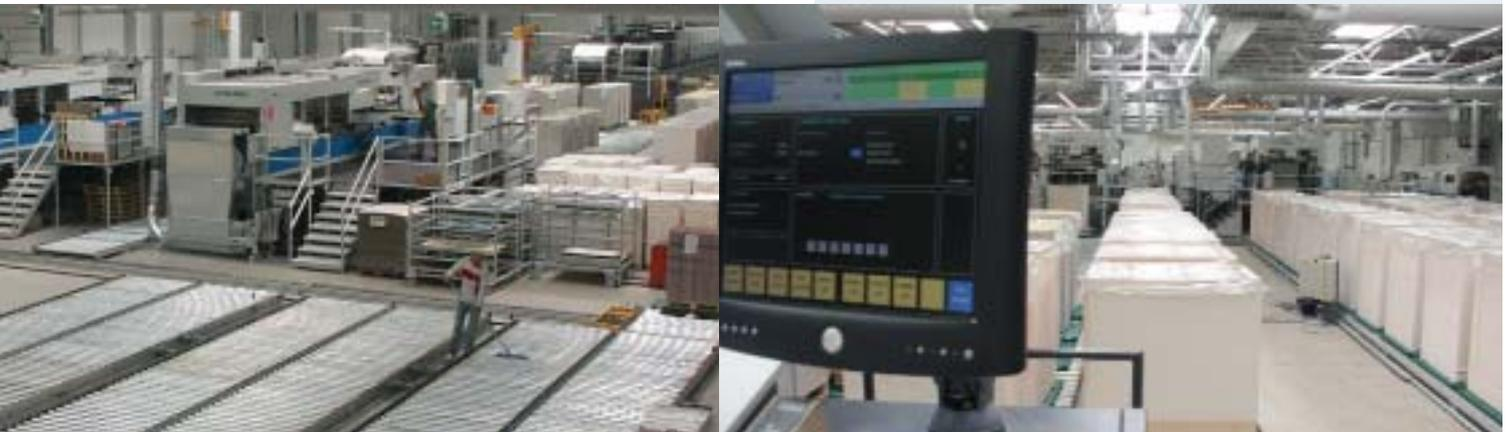
Material hinter den Maschinen wird von den Druckern automatisch per Knopfdruck über das Logistiksystem abgefordert. Der Materialvorrat beträgt bis zu 15 Stunden.
