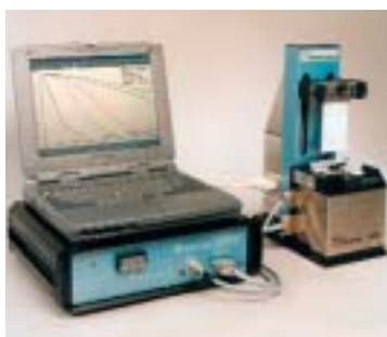
Mit dem emcoDPM wird im Labor das dynamische Verhalten des zu verarbeitenden Papiers gemessen.
