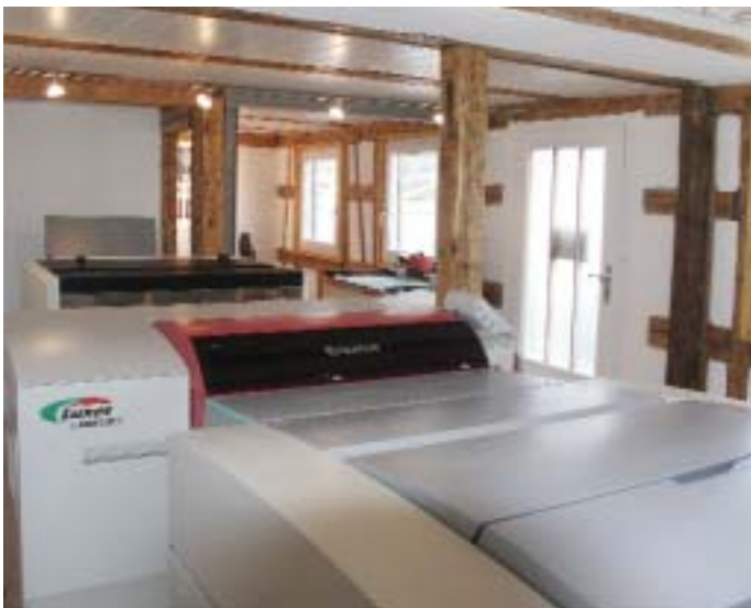
Das CtP-System Fujifilm Luxel T-6000 CTP E wurde europaweit erstmals beim Druckhaus Zanker als MAL-Vollautomat installiert. Für das neue CtP-System wurde eigens ein Raum eingerichtet. Dabei wurde die alte Bausubstanz des Fachwerkhäuses erhalten. Der CtP-Belichter versorgt die elf Druckwerke beim Druckhaus Zanker.
