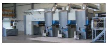
Achim Kurreck (Bild oben) erläutert die maschinentechnischen Details der 3TBR. Die Bogentiefdruckmaschine ist lieferbar für die Formate 52 x 74 cm und 78 x 114 cm, kann bis zu acht Druckwerke umfassen und verarbeitet Papier und Karton von 70 g/m² bis 400 g/m² bei einer Leistung von bis zu 12.000 Bogen/h. Eingesetzt werden IR- oder UV-Trockner
