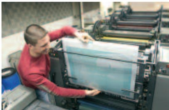
werden, die später chemisch zu stabilen Druckbildern entwickelt werden müssen, erfordert die Azura nur einen Schritt zum Reinigen bzw. Gummieren der nicht druckenden Flächen.
