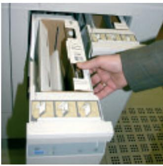
Eines der beiden Vorratsfächer für die Spezialumschläge an der Bindomatic 301 DFS. Die Umschläge gibt es in Rückenstärken von 1,5 mm, 3mm, 6 mm und 13 mm für Bindungen bis 120 Blatt Papier in der Grammaturn 80 g/m<sup>2</sup>.
