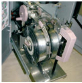
Der integrierte Finisher der Digimaster E150 heftet bis zu 100 Blatt starke Broschüren. Die Digimaster E150 mit einem Papiermodul, Finisher und der Online-Anbindung an die Bindomatic 301 DFS von Bindomatic. Das digitale Produktionssystem Digimaster 9110 mit zwei Papiermodulen und Finisher (rechts).
