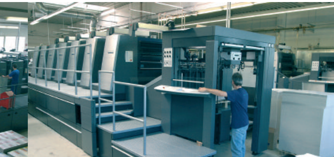
Blick in den Drucksaal: Neben zwei Speedmaster CD ist die Speedmaster XL 105 installiert, die bei Hepack bereits über 17 Mio. Drucke produzierte.
