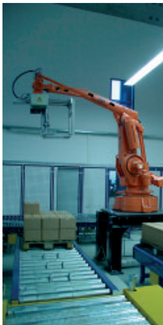
Typische Hepack-Verpackungen, gedruckt auf der Sechsfarben-Speedmaster XL 105 mit Lackierwerk. Versandfertige Produkte werden mit einem Roboter auf Paletten gesetzt.
