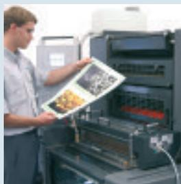
Diese bei der GTO 52 bewährte Lackiereinrichtung wird nach dem letzten Druckwerk eingesetzt. Druck und Lackierung erfolgt damit in einem Durchgang. Möglich sind UV-, Dispersions- und Blisterlacke, Spezialanwendungen wie Vollflächen-, Spotlackierung oder Effektlackierungen. Auch kleinere Druckereien
