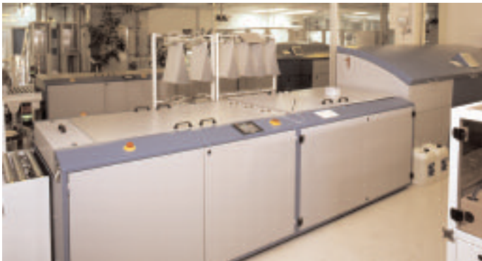
Die CtP-Straße (unten im Bild eine der drei neuen Violet-Strecken) wird weitestgehend unter Tageslicht-Bedingungen betrieben.
