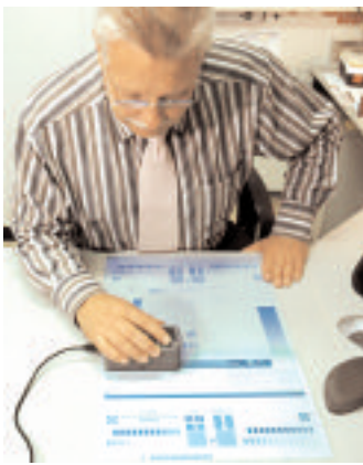
Jochen Imhof demonstriert an einer Kodak VioletNews die messtechnische Kontrolle der hauseigenen Testform, die auch zu Drucktests herangezogen wird.
