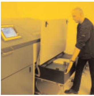
Die Trolleys der Violettplattenbelichter können unter gelbem Schutzlicht mit VioletNews-Platten befüllt werden.
