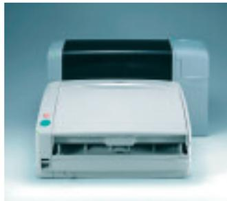
Dabei verfügen Dokumentenscanner über einen Dokumenteneinzug, den Feeder, der einen Blatteinzug mit einer Geschwindigkeit ab 10 Seiten pro Minute ermöglicht. Tagesdurchsätze von 8.000 bis 38.000 Seiten (bei 80 S/min) werden so erreicht. Dabei lassen sich die Modelle nach ihrer Scangeschwindigkeit in fünf Klassen unterteilen:
