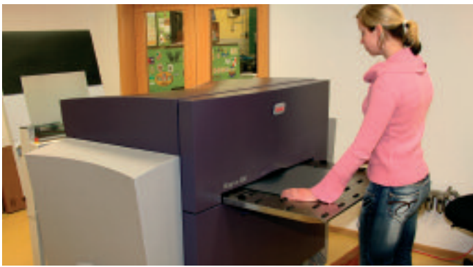
Die Auszubildende Lisa Schmeing legt am Tisch des Magnus 400 eine Kodak Thermal Direct für den Einzug an. Hinter der kompakten CtP-Maschine kommt, abgesehen von einer kleinen Stapelvorrichtung für die fertigen Platten, nichts.
