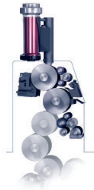
Das farbzonenselektive Farbwerk Anicolor feiert in einer Speedmaster SM 52-Vierfarbenmaschine Premiere. Das Farbwerk hat weniger Walzen als ein konventionelles Werk. Dadurch erfolgt eine sehr schnelle Einfärbung und es werden extrem wenige Anlaufbögen benötigt – je nach Drucksujet nur 10 bis 20 Bögen.
