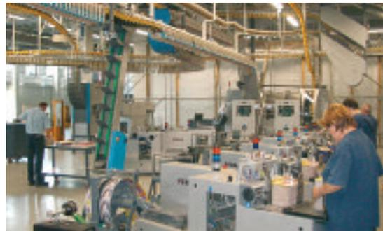
raums fiel die Wahl auf ein Ferag-System mit Einstecktrommel MSD2-C, Sechser-RollStream, zwei Paketausleger
