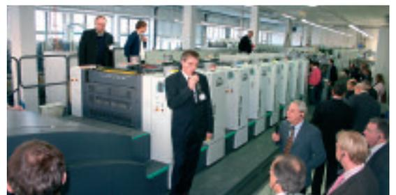
druck. Die Leistungsstärke der Roland 500 mit InlinePerfector wird auch bei den kurzen Rüstzeiten und der Materialflexibilität deutlich. Das gilt nicht nur für die üblichen Konfigurationen, sondern auch für Langperfektoren mit bis zu zehn Druckwerken und für Lackperfektoren mit zusätzlichen Lackmodulen.
