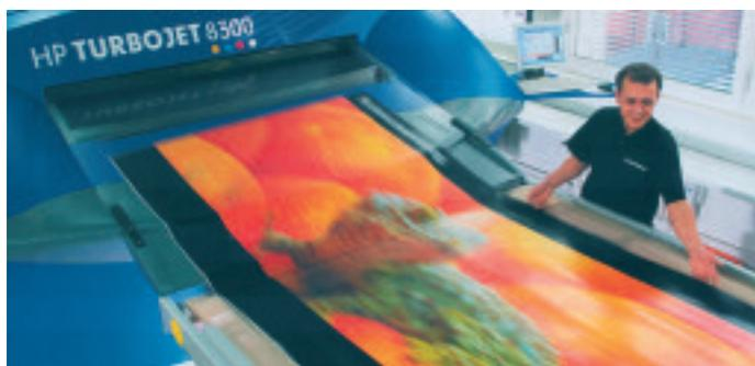
Der Turbojet von Christinger Partner ist der erste weltweit, der die Anforderungen des Prozess Standard Offset nach ISO 12647 Fogra Matt erfüllt und Drucke erzeugt, die in ihrer farblichen Wirkung von Offsetdrucken nicht zu unterscheiden sind. Im Digitaldruck lässt sich von einem Druck zum nächsten bei voller Produktionsgeschwindigkeit das Sujet wechseln. Dies erlaubt es, eine Auflage auf beliebig viele Sujets zu verteilen und die Werbebotschaft exakt
