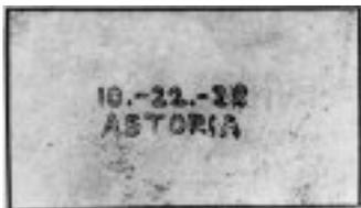
der Physiker Otto Kornei, schrieb das historische Datum auf ein Mikroskopglas und legte es auf eine Platte mit elektrostatisch aufgeladenem Schwefel. Nach kurzer Belichtung entfernten die Forscher das Mikroskopglas und streuten Bärlappsamen auf die Platte: Ein nahezu perfektes Abbild der Zeichen erschien. Die Xerografie (griechisch für »trocken schreiben«) war geboren.
