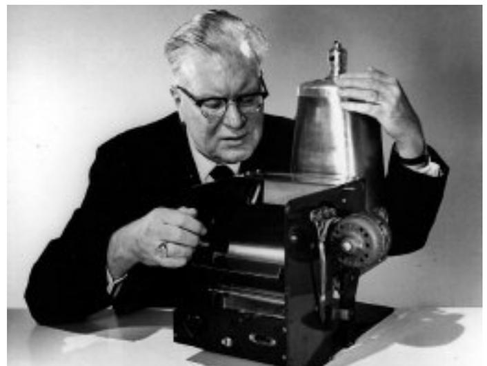
baut sich die elektrische Ladung wieder ab. Es entsteht eine elektrisch neutrale Abbildung der Vorlage auf der ansonsten geladenen Trommel. Im nächsten Schritt kommt der Toner ins Spiel. Das feine Farbpigmentpulver wird wie die Trommeloberfläche elektrisch geladen. Die beiden Pole stoßen sich ab, so dass sich der Toner nur auf den elektrisch neutralen Zonen absetzt. Das so auf der Trommel entstandene Bild wird auf
