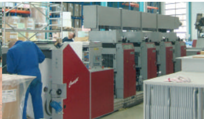
Die Concept mit vier Druckwerken wurde 2004 installiert und ist für den UV-Druck in einer Breite von 52 cm ausgelegt. Auf der Maschine können extra leichte Papiere bis hinunter zu 28 g/qm bedruckt werden, was gerade für Mailings besonders interessant ist.
