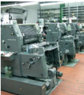
Eine ganze Reihe an Heidelberger Druckmaschinen sind im Bereich Kleinformatdruck neben altgedienten Heidelberg-Buchdruckmaschinen für Veredelungen wie Stanz- und Präge-Applikationen im Einsatz.
