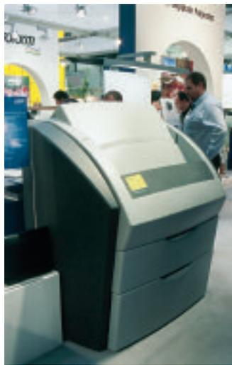
Das DPX-System – der Hersteller ist Esko-Graphics – ist das Flaggschiff der CtP-Systeme für Bebilderungen von Polyesterplatten für das Druckformat B3. Entwicklungssektion und Stanze sind integriert.
