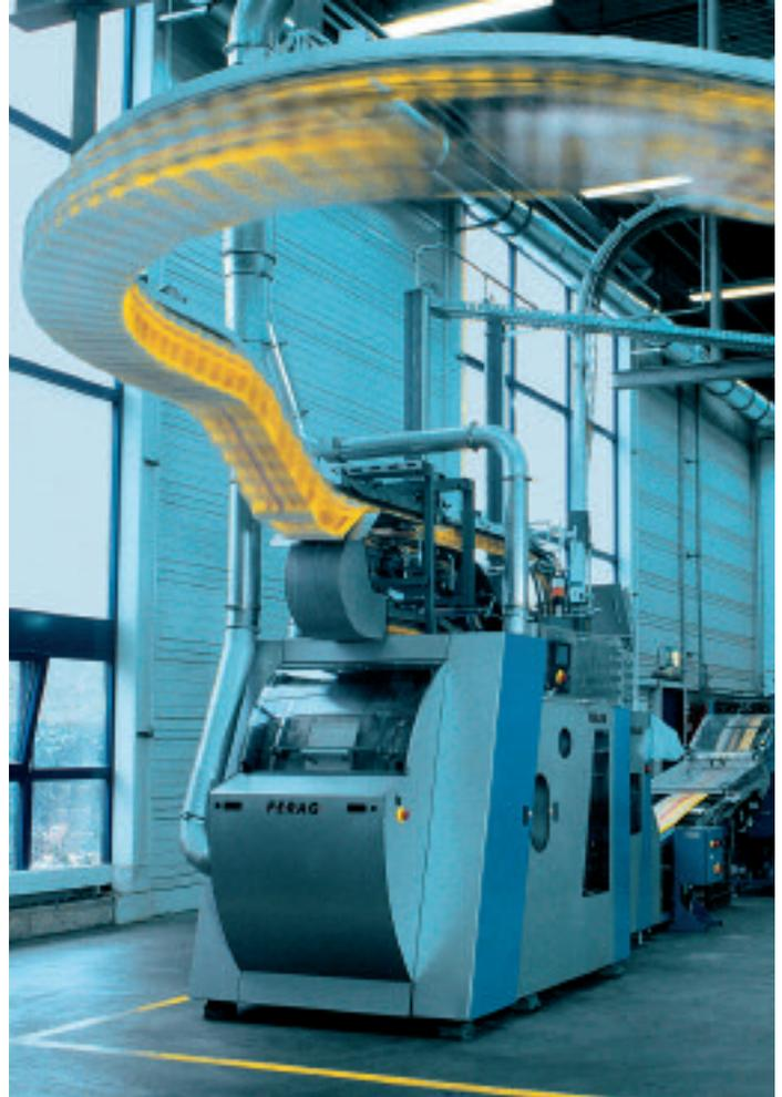
Auf Basis der UniDrum hat Ferag eine Lösung für die Doppelnutzenproduktion bei 60 000 Ex./h und Produktlängen von 440 mm vorgestellt. Mit durchgängiger Inline-Fertigung kann das Leistungspotenzial des Systems genutzt werden.
