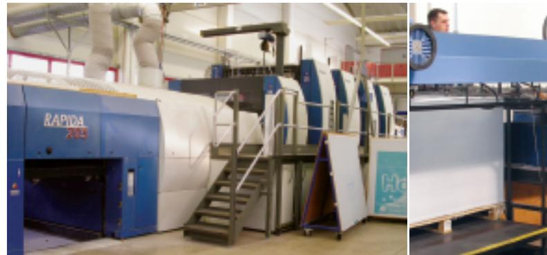
Dazu wurde eine Wellpappenherstellungsmaschine installiert, die Wellpappe in drei verschiedenen Wellenarten mit einer Rollenbreite bis zu 160 cm fertigen kann. Die im Offset-Großformat hergestellten Drucke werden dann inline auf die Umverpackungen kaschiert und zu Faltschachteln oder Displays weiterverarbeitet.
