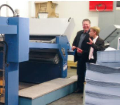
Mabeg-Paletten-Anleger eingesetzt. Durch einen integrierten Inkjetdrucker wird jeder Bogen beschriftet. Die Falzmaschine ist mit zwei Falzwerken ausgerüstet: das erste Falzwerk mit sechs Taschen und das zweite Falzwerk mit zwei Taschen. Da es sich beim zweiten Falzwerk um ein mobiles Falzwerk handelt, ist
