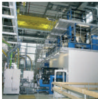
Am Ausgang der Cortina, hinter jedem Falzapparat, befindet sich eine Transportkette für die fertigen Produkte. Für die gesammelte Produktion funktioniert die Transportkette zum Versendraum im Rhythmus der Druckmaschine. Für die Produktion mit einfachem Falz nimmt jede Klammer zwei Hefte gleichzeitig auf, so dass die Laufgeschwindigkeit gleich bleibt.
