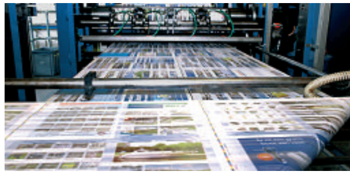
An der KBA Cortina bei Dijkman kann wegen der fehlenden Zonenschrauben und Feuchtwerke ohne großen Aufwand bei ganzbreiten Papierbahnen stufenlos zwischen 1.260 und 1.680 mm Bahnbreite variiert werden. Daraus ergibt sich die für einen Lohn-drucker wichtige große Formatflexibilität
