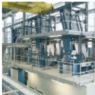
Der Oberbau der KBA Cortina mit je zwei Falztrichtern pro Falzapparat ermöglicht viele Produktionsvarianten. Demnächst auch mit einer Heatset-Bahn.
