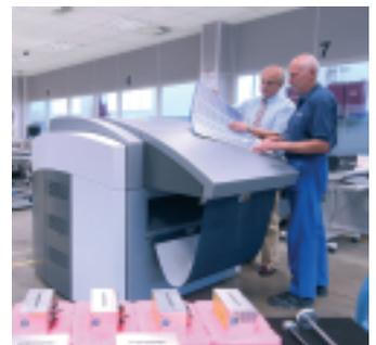
Beim Innentrommelbelichter Prosetter dreht sich ein Spiegel auf einer Achse (die Belichtung der Platte erfolgt über eine Optik) mit 54.000 Umdrehungen pro Minute. Bei 100 Millionen Belichtungspunkten pro Sekunde bedeutet dies 10 Nanosekunden pro Punkt.
