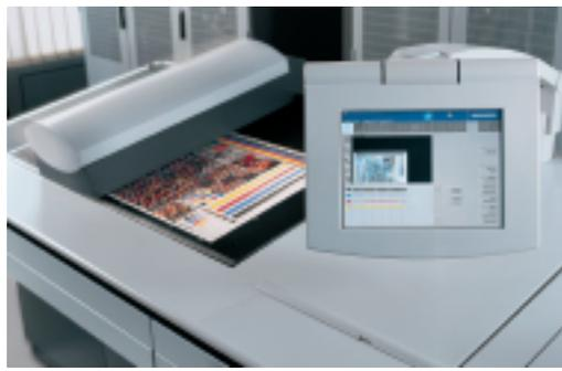
Prinect Axis Control ist in das Steuerpult Prinect CP2000 Center der Druckmaschine integriert und misst spektralfotometrisch im Farbmessstreifen.
