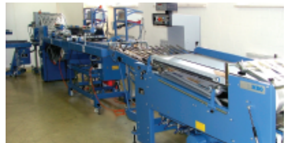
Rundstapelanleger R 530 mit Schneid- und Falzwerk.
