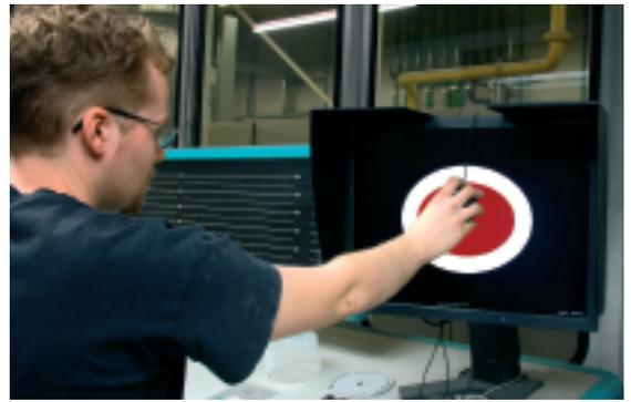
PDF-Dateien, die im Workflow-System vorliegen. Die Farbanpassung der Proofbilddaten zur Simulation des Rollenoffsetdrucks auf verschiedenen Papiertypen übernimmt die Matchprint Virtual-Software, die mit ICC-Profilen arbeitet.
