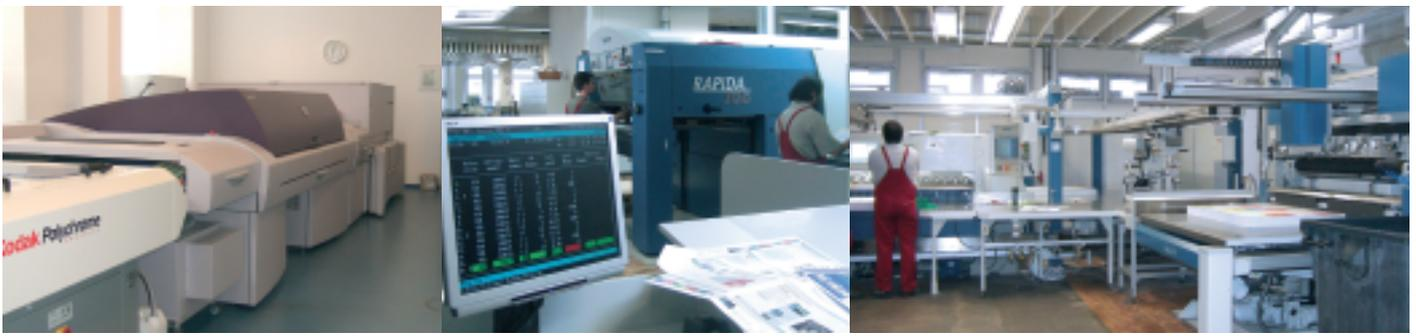
Administration (Hiflex MIS), Druckvorstufe (Kodak) und Drucksaal (MAN Roland) sind bereits seit 2003 via JDF miteinander vernetzt. 2005 wurde auch eine KBA-Bogenmaschine in das unternehmensweite Netz integriert. Seit Januar 2007 produziert das Druckhaus Berlin-Mitte mit einer Sechsfarben KBA Rapida 105, die ebenfalls per JDF vernetzt ist. Im Vordergrund ein Hiflex BDE-Terminal.
